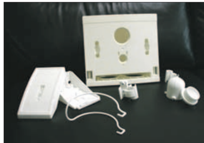
Polyamid- eller nylondele fremstillet direkte fra 3D Cad-tegninger ved Rapid Prototyping indgik i model- og prototypeudvikling og test.
