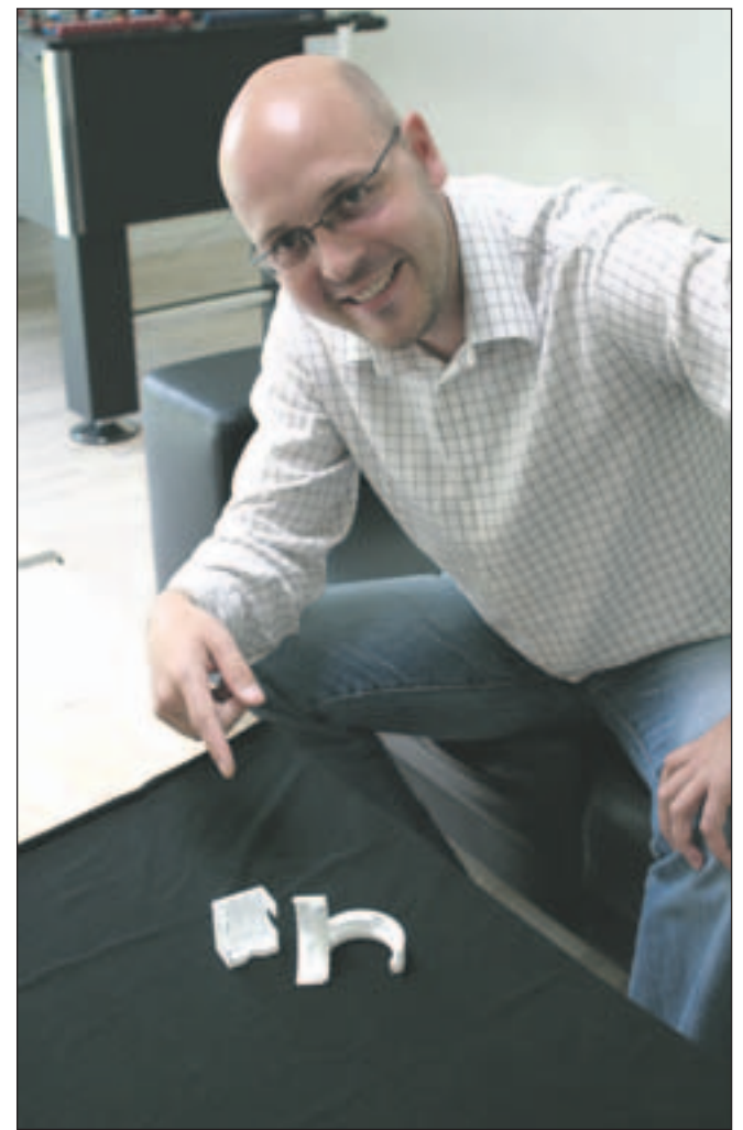
Morten Andersen viser her nogle rapid manufacturing dele, der indgår i dentalt sandblæsningsudstyr. Kunden sparer derved plastsprøjtestøbeforme.
